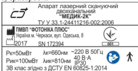
Аппарат лазерный сканирующий двоканальный «МЕДИК-2К» ТУ У 33.1-24411216-002:2006-наименование и обозначение аппарата и технических условий на него;
